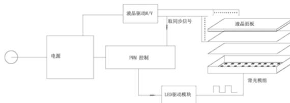
1. 一种高光效的TFT-LCD背光显示驱动系统,其特征在于,包括:电源、外部驱动装置、LED灯和液晶面板,所述外部驱动装置包括液晶驱动、PWM控制以及LED驱动模块;
