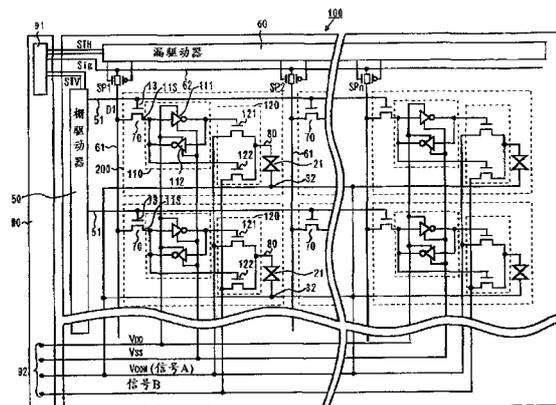
1. 一种液晶显示装置,将在基板上的一个方向上配置的多个栅信号线、在与所述栅信号线交叉方向上配置的多个漏信号线、以及显示像素配置成矩阵状,所述显示像素由来自所述栅信号线的扫描信号加以选择,并由所述漏信号线供给图像信号,
